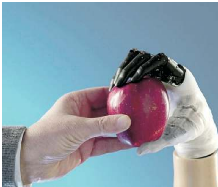
HANNES La nuova mano robotica italiana di Rehab Technologies
