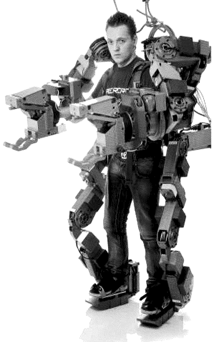
Iron Man esiste già ed è tutto made in Italy Il body extender per uso industriale (carico e scarico) prodotto dal laboratorio Percro di Pisa
